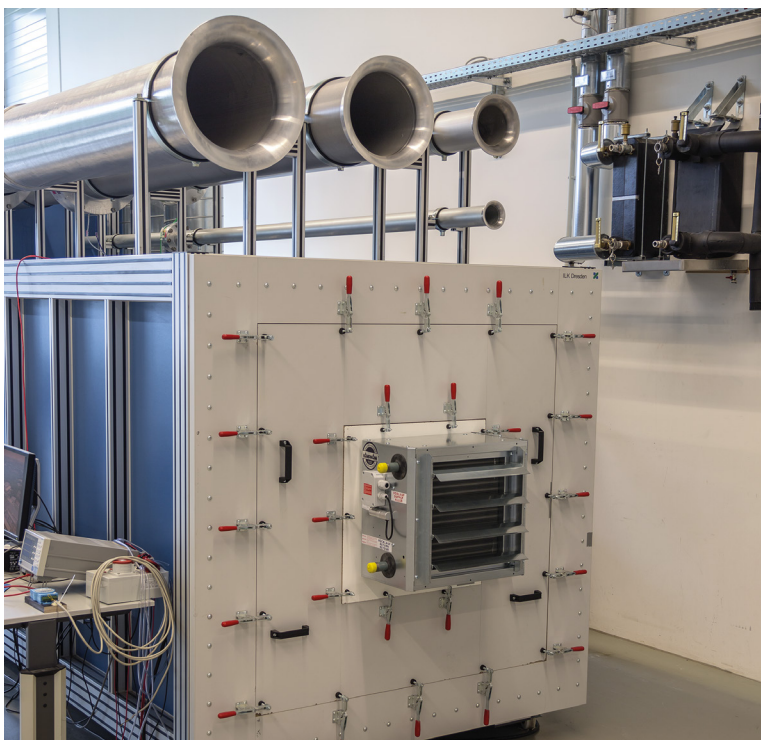
Testopstelling voor het meten van luchtvermogen volgens DIN EN ISO 5801, Kampmann F&E Center
