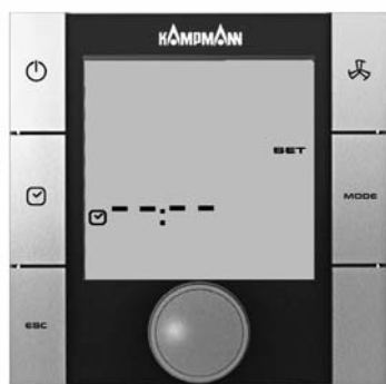
Instelling voor onderdrukking van de tijd in het standaarddisplay
