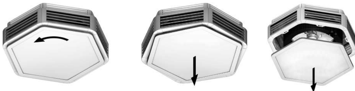
Afb. 32: Deksel van de behuizing demonteren
