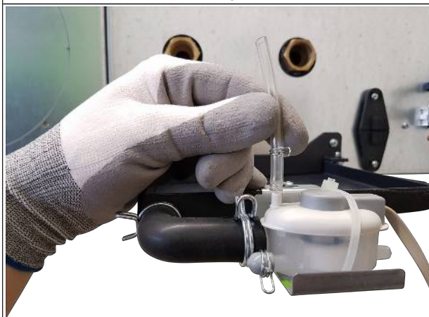
Afb. 24: Ontluchting aanbrengen
