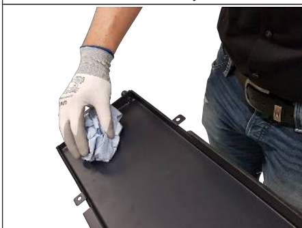
Afb. 63: Condensaatbak reinigen
